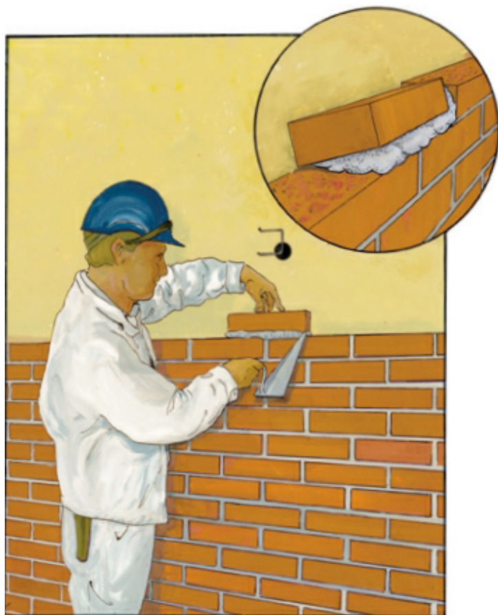
Om stenen läggs såsom bilden visar minimeras risken för att överflödigt murbruk faller ner i luftspalten bakom teglet och fyller luftspalten med bruk längst ner.
